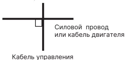
Рис. 4-2 Требования к электрическим подключениям
